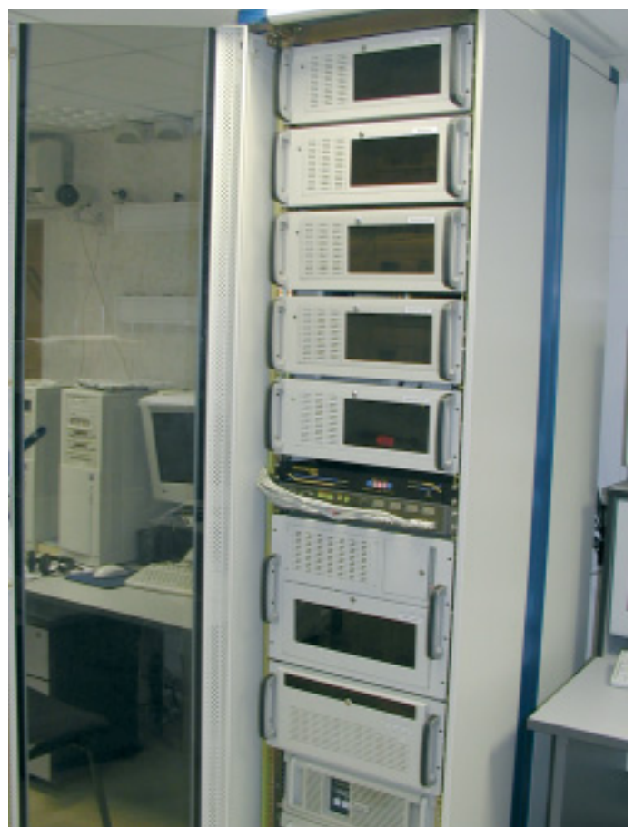
Стойка с видеосерверами и RAID-массивами
