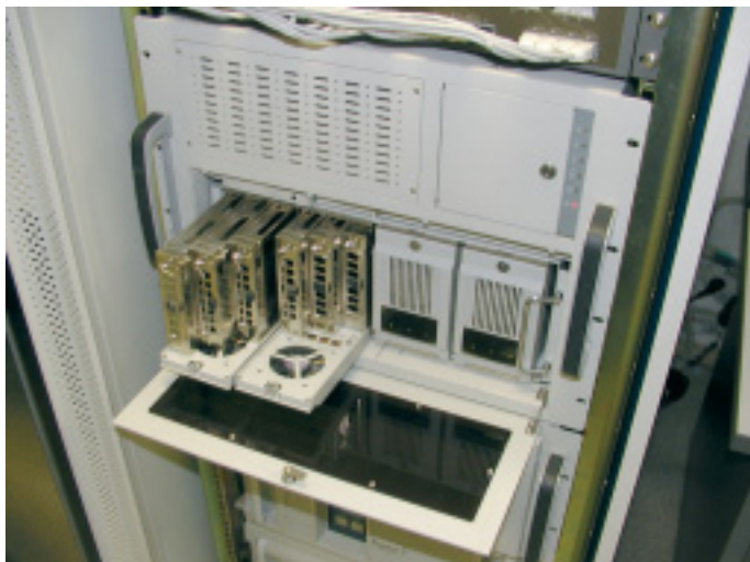
Такой же RAID-массив пятого уровня с корзинами дисков был установлен на объекте Минатома
